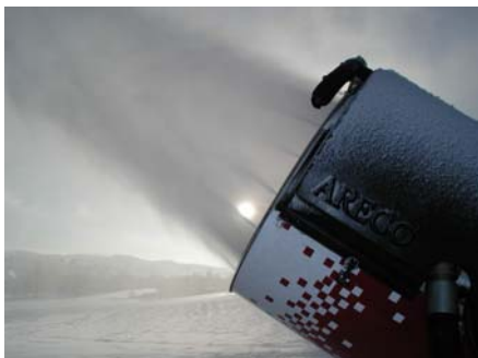
Obr.6: Tvar proudu vodních kapek vyletujících ze sněžného děla.
