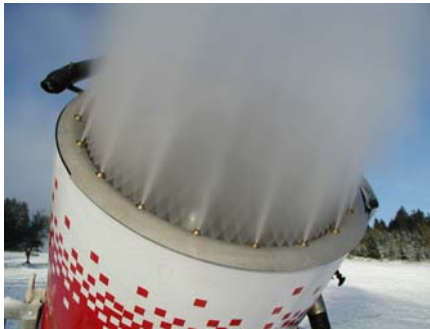
Obr. 5a): Rozmístění trysek v nukleačním okruhu sněžného děla (např. ARECO má 20 trysek)
