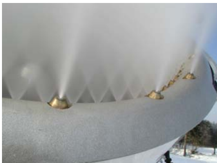
Obr. 5b): Rozmístění trysek v ústí sněžného děla – detailní záběr. Je zde zřetelný rozdíl mezi rozmístěním trysek a charakterem vodních kapek vyletujících z trysek vnějšího, nukleačního okruhu a okruhů ostatních.
